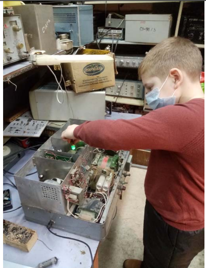
Бекер Ефим наблюдает за работой средневолнового АМ-передатчика на эквивалент нагрузки.
