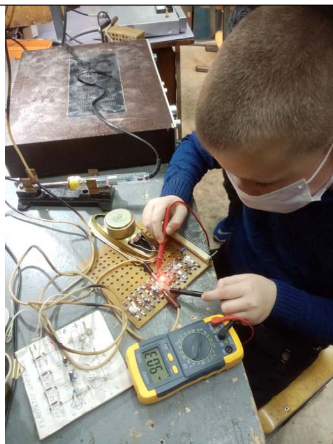
Шпаков Артём 2кл. проверяет схему на 4-х транзисторах (генератор с переменной тональностью). Собирал сам и сам делал макет.
