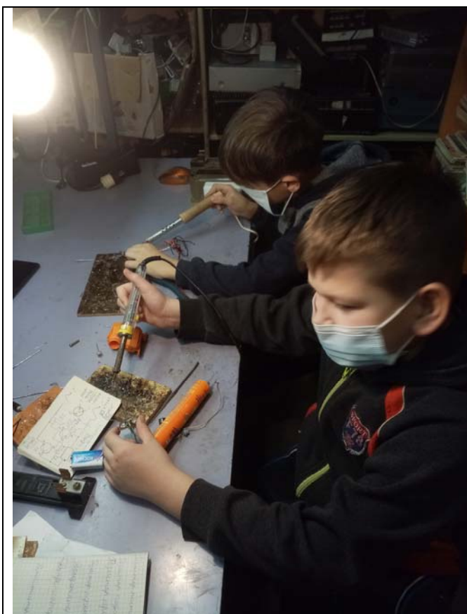
Селезнёв Тимофей (ближе) 4кл. Балдин Александр (дальше) 4кл. в процессе сборки несимметричного мультивибратора для звуковой прозвонки.
